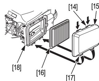
**NOTE :** L'élément papier du filtre à air doit être sec pour fonctionner. Ne pas l'imbiber d'huile. Ne pas utiliser de brosse pour nettoyer l'élément.
