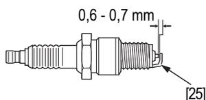
**NOTE :** Après repose sur son siège, serrer une bougie d'allumage neuve de 1/2 tour à l'aide d'une clé pour comprimer la rondelle. S'il s'agit de remonter une bougie usagée, 1/8 à 1/4 de tour suffira.
